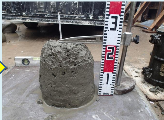
高強度コンクリートの試験結果 (一般のスランプコンクリート: 約10cm)
