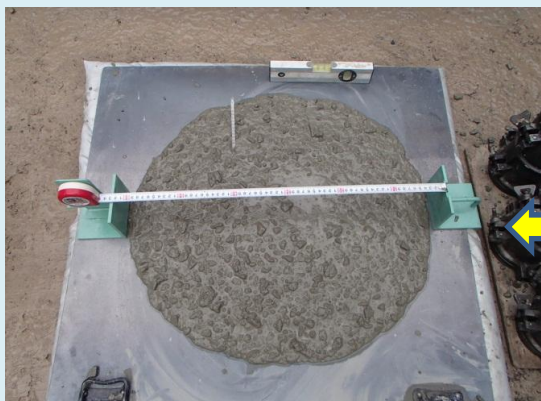
高流動コンクリートの試験結果 (60cmくらい広がります)
